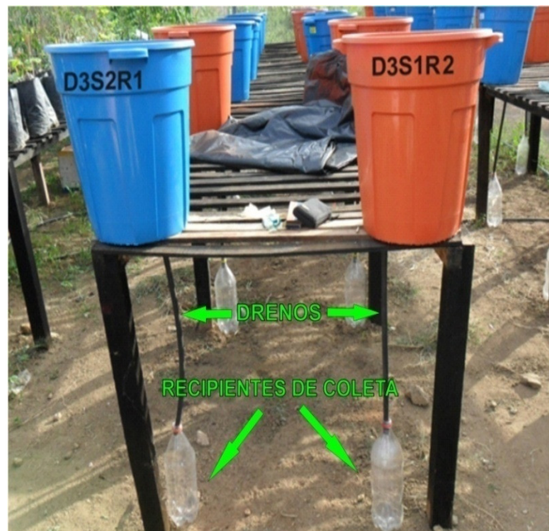
Figura 4: Sistema de coleta de drenagem.
