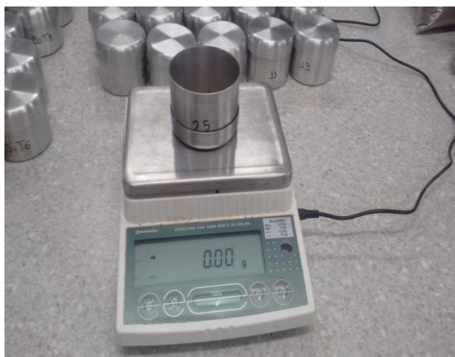
**Figura 3.** Pesagem do solo seco dos tratamentos estudados.
