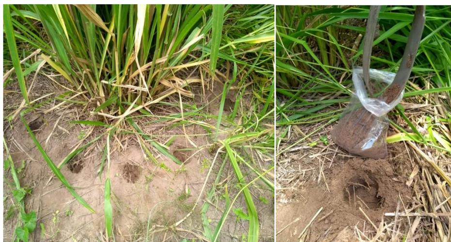
**Figura 2.** Coleta das amostras de solo com auxílio do trado holandês.
