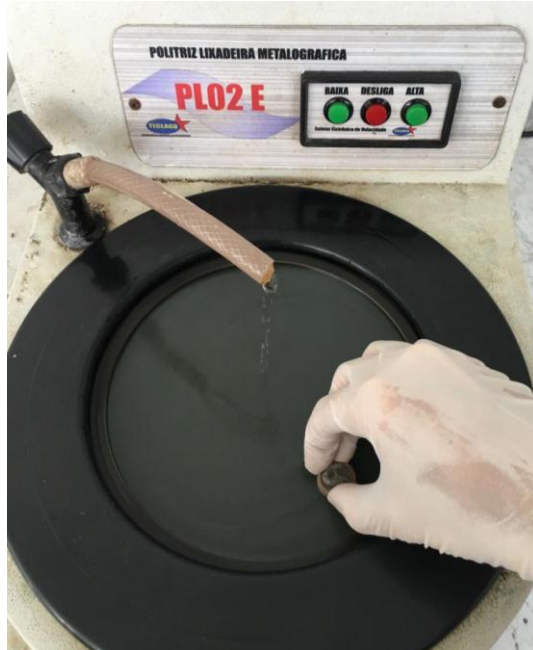
Figura 5. Lixamento das amostras em uma Politriz Lixadeira Metalográfica PL02 E.
