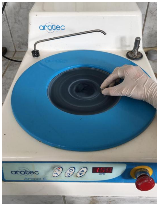
Figura 6. Polimento das amostras com a pasta Diamond R em uma Politriz Aropol E.
