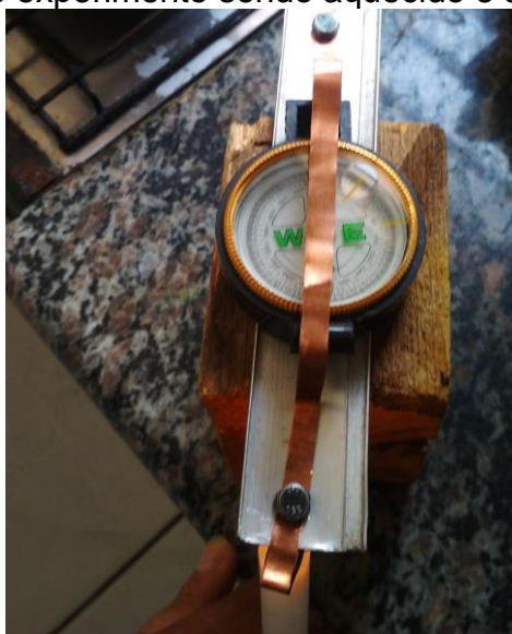
Figura 12 – Segundo experimento sendo aquecido e agulha sendo defletida
