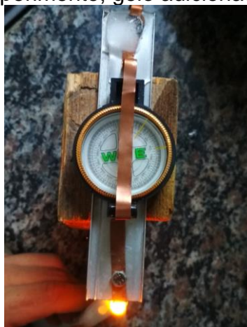
Figura 16 – Segundo experimento, gelo adicionado na extremidade oposta
