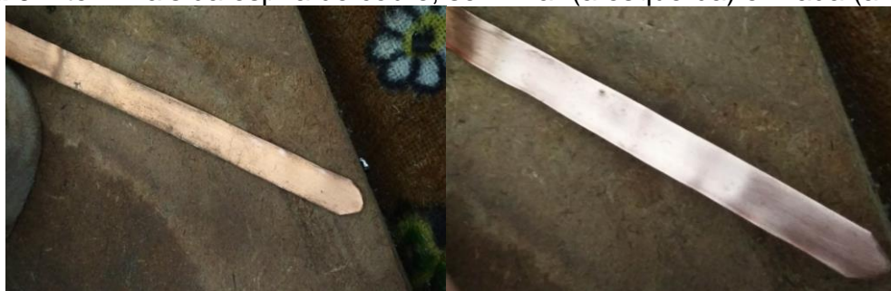
Figura 5 – terminais da espira de cobre, sem lixar (a esquerda) e lixada (a direita).
