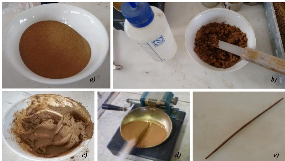
Figura 08 - a) solo peneirado; b) adição de água destilada; c) solo pronto para realização do ensaio; d) realização do ensaio de LL no Aparelho de Casagrande; e) rolagem do solo no ensaio de LP.
