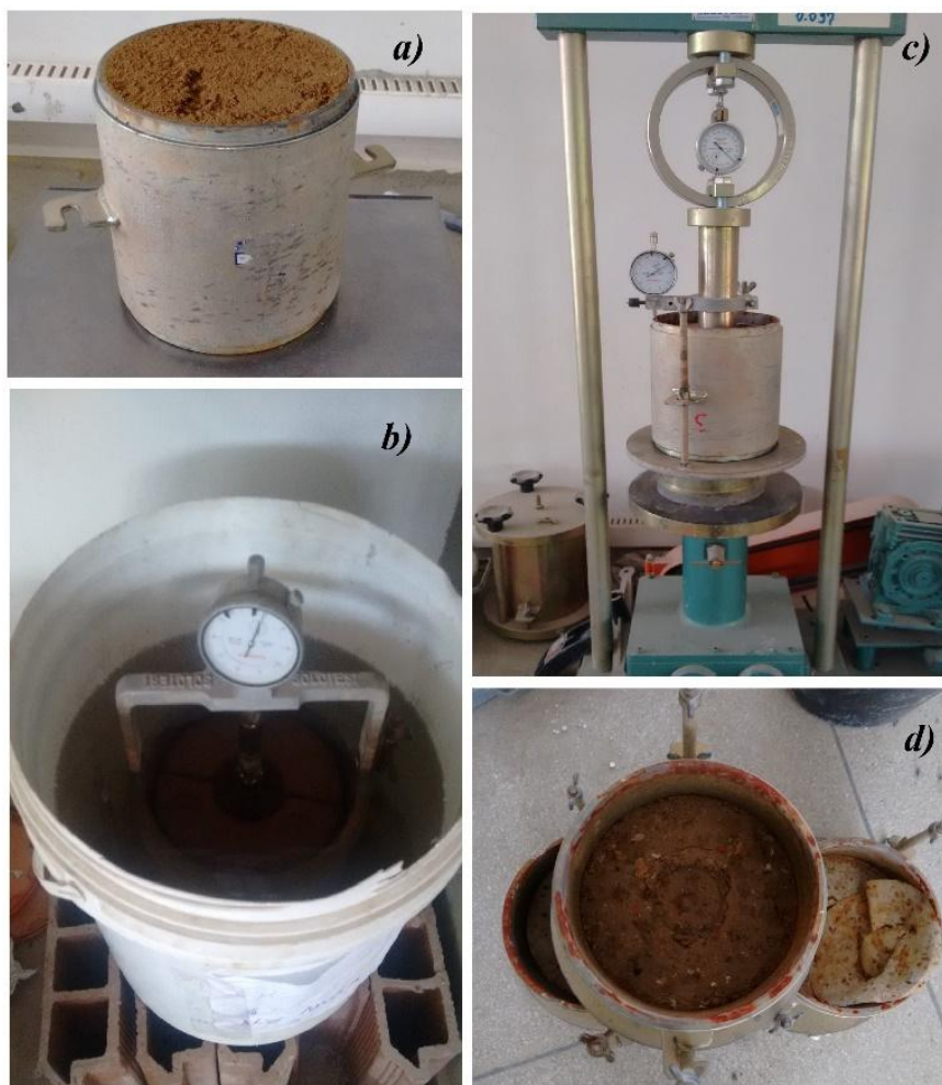
Figura 10 - a) corpo-de-prova moldado na umidade ótima; b) imersão em água destilada; c) penetração do pistão no corpo-de-prova; d) corpos-de-prova rompidos após o ensaio.
