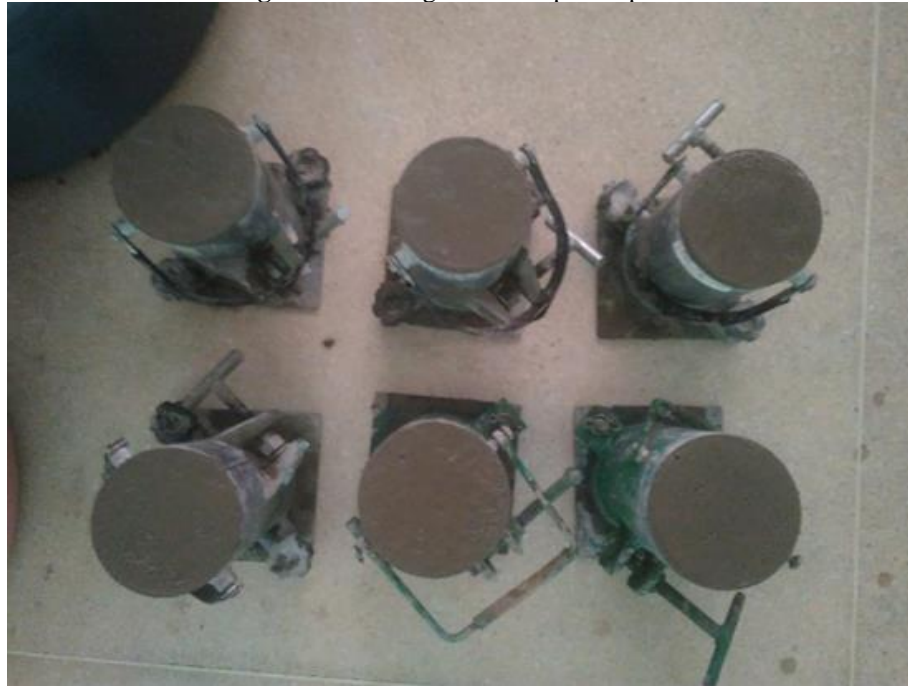
Figura 9 - Moldagem dos corpos de prova
