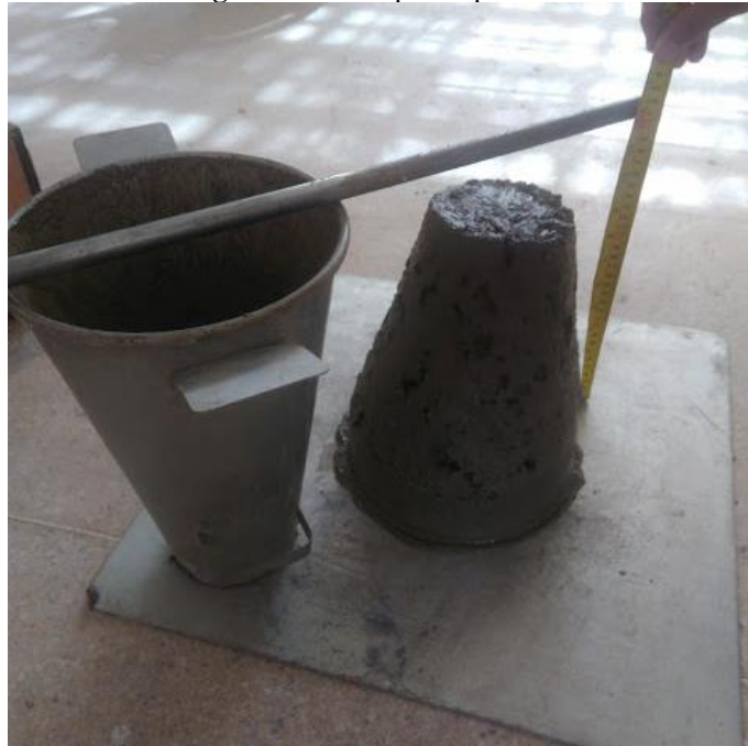
Figura 10 - Slump Test para C30
