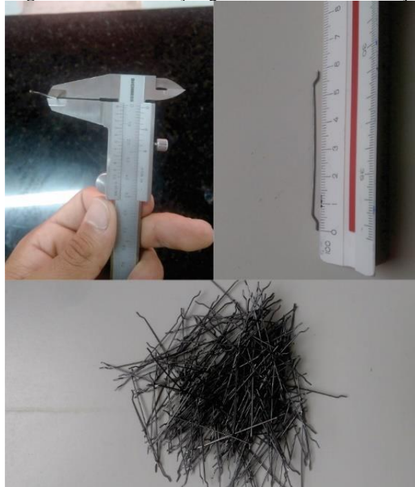
Figura 6 – Caracterização geométrica das fibras de aço
