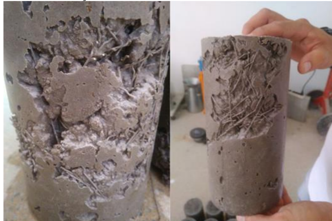
Figura 13 - Aglutinação das fibras de aço no corpo de prova endurecido para os maiores teores de fibra de aço no concreto de classe C30
