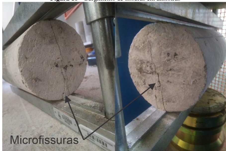
Figura 16 – Surgimento de fissuras em amostras
