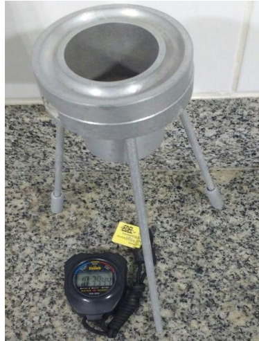
Figura 3 - Viscosímetro VT-2000I e cronômetro
