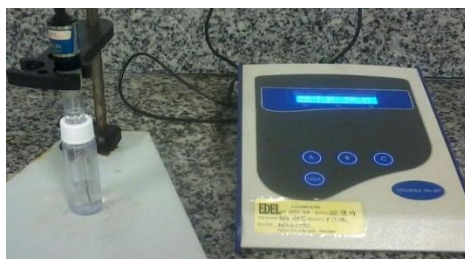
Figura 2 - Medidor de PH de Bancada (Microprocessado) MPA-210.
