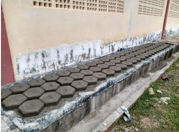
Figura 9. Preparação artesanal dos tijolos do HB/CH/UEPB para o piso dos caminhos e pracinhas, Novembro, 2019.
