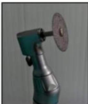
**Figura 01.** Disco de *carborundum* acoplado à baixa rotação utilizado para corte dos dentes e raízes utilizados na pesquisa.
