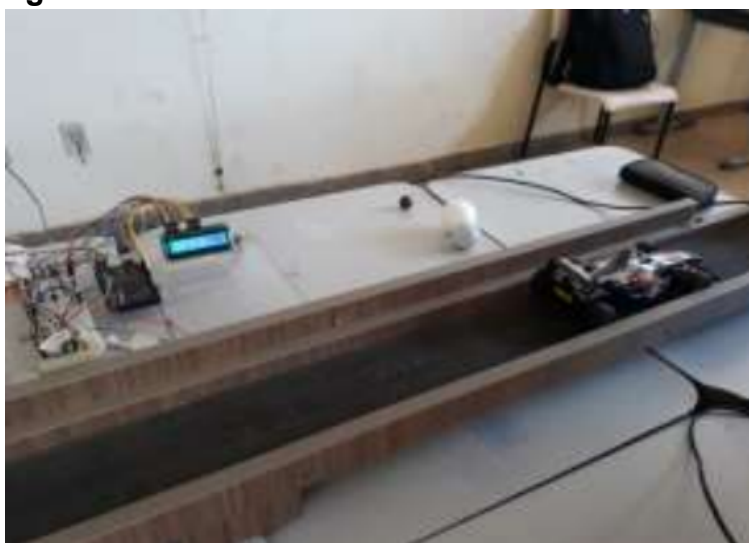
Figura 2 - Bancada contendo os sensores e o Arduino
