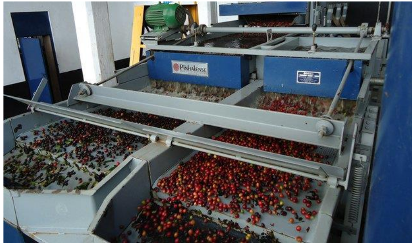
Figura 7 - Sistema mecânico para lavagem e separação hidráulica do café.
