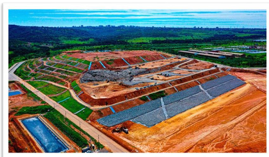
Figura 1: Aterro tecnológico, proteção e isolamento do solo.
