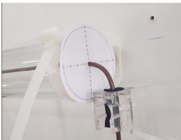
Figura 12 - Acoplamento do tubo de Pitot no suporte.
