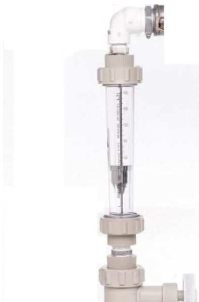
Figura 3 - Rotômetro adaptado em uma tubulação para medir vazão.
