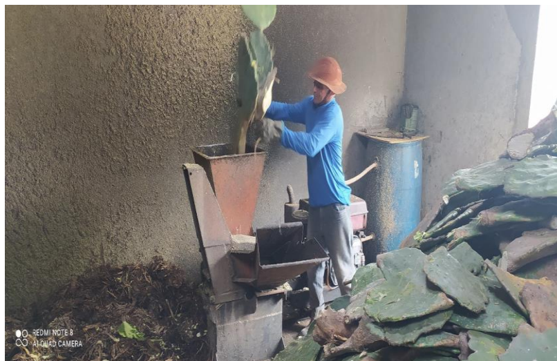
Figura 3 - Ilustração de um agricultor utilizando a forrageira para moagem da palma.
