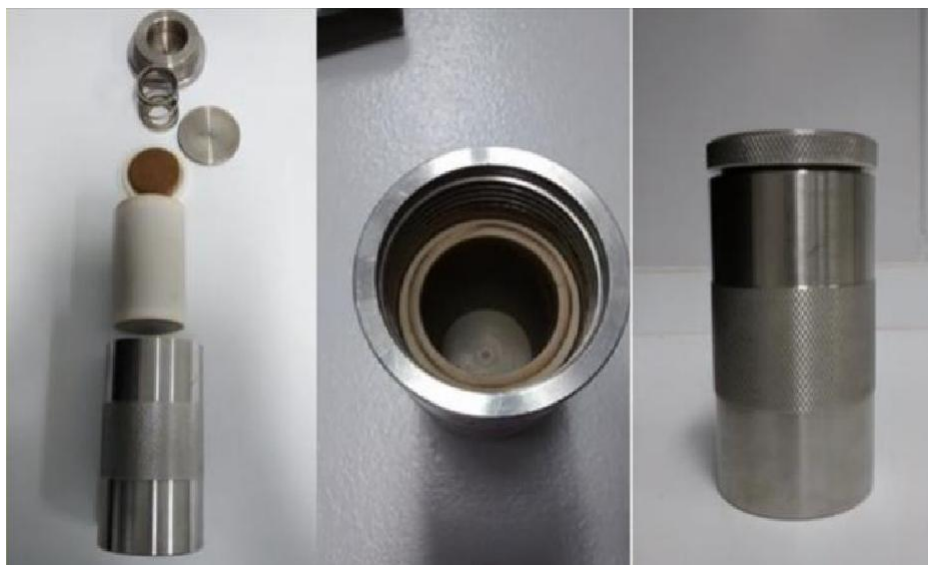
Figura 6 - Autoclave utilizada para a síntese hidrotérmica do Al-MCM-41
