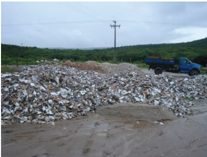
Figura 51: Retraços de porcelanato em estoque para ser moído. Fonte: Pesquisa de campo (2011)
