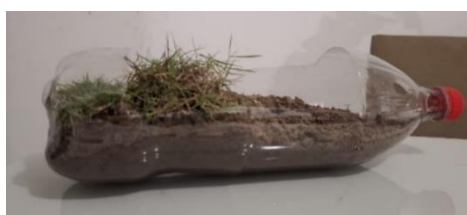
Figura 8 – Simulação do escoamento superficial em área urbana.
