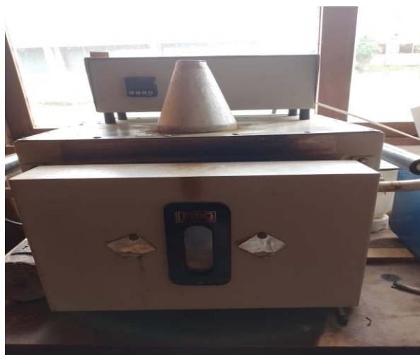
Figura 1 – Forno mufla Jung® utilizada no processo de produção do biocarvão de cama de
