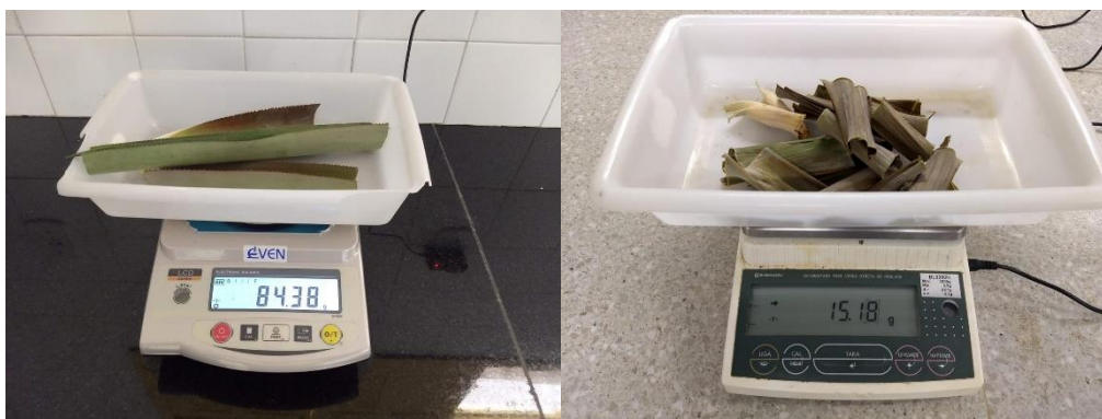
Figura 7 - Determinação da massa verde e seca das folhas de abacaxizeiro.
