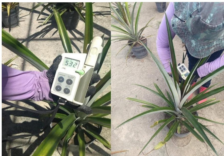
Figura 9 - Determinação do teor de clorofila pelo índice SPAD.
