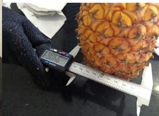
Figura 12 - Diâmetro do fruto mensurado com o auxílio de um paquímetro digital.
