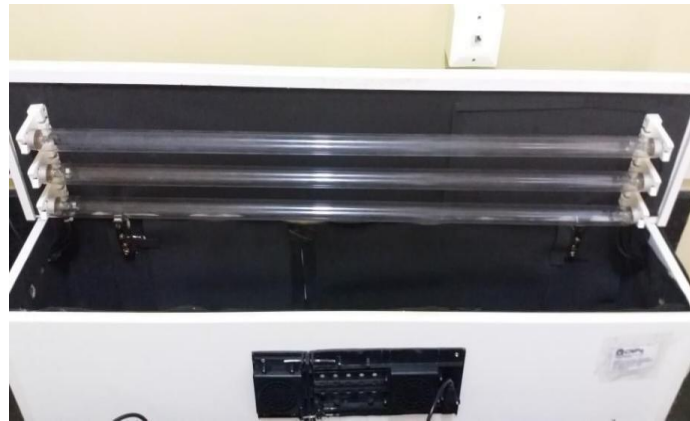
Figura 4: Fotoreator utilizado nos testes fotocatalíticos
