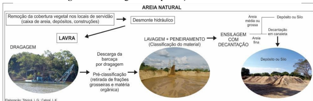
Figura 1 – Fluxograma da produção de areia natural
