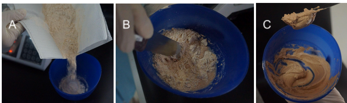
Figura 41 - (A) - Dispensação do gesso na água; (B) - Espatulação inicial; (C) - Consistência homogênea final.
