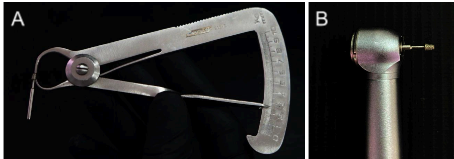
Figura 59 - (A) Mensuração da espessura da ponta diamantada 2131 utilizando o espessímetro de Iwanson; (B) Ponta diamantada 2131 inserida na caneta de alta rotação.
