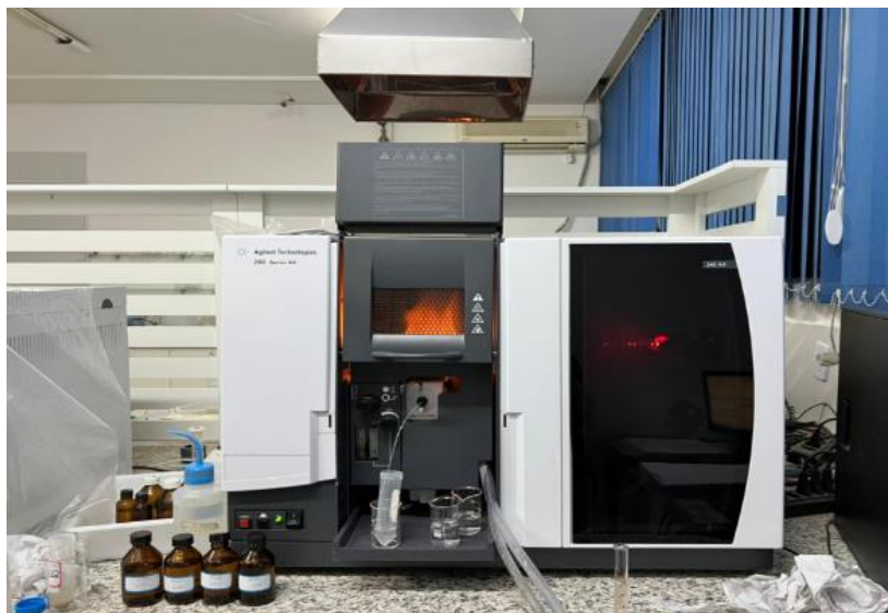
Figura 11: Análise das concentrações dos metais no Agilent/AA240
