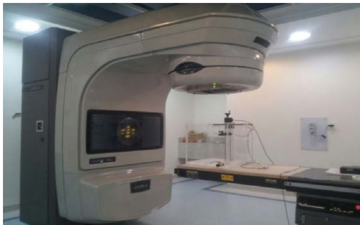
Figura 11 Acelerador linear, mesa de tratamento, phantoms e câmara de ionização.
