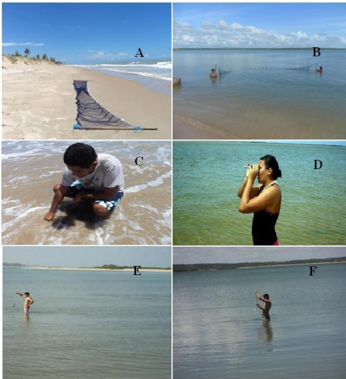
*Figura 7 – Metodologia das coletas nos quatro pontos amostrais. A – rede de picaré; B – Arrasto; C – Aferição de temperatura; D – Aferição de salinidade; E e F – Medição de transparência e profundidade.*
