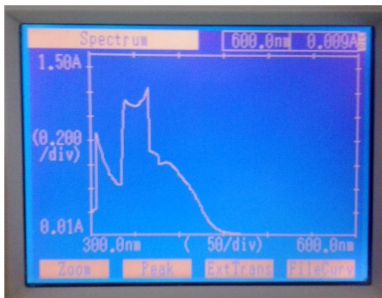
Figura 5- Espectro de varredura do 5CN05-LSVM no UV MINI - 1240 (Shimadzu), onde pode ser observado o \lambda máximo de absorção em 388nm.
