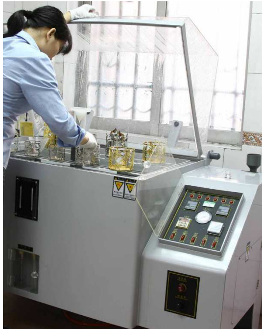
Figura 8 - Câmara de Salt Spray com objetos suportados.
