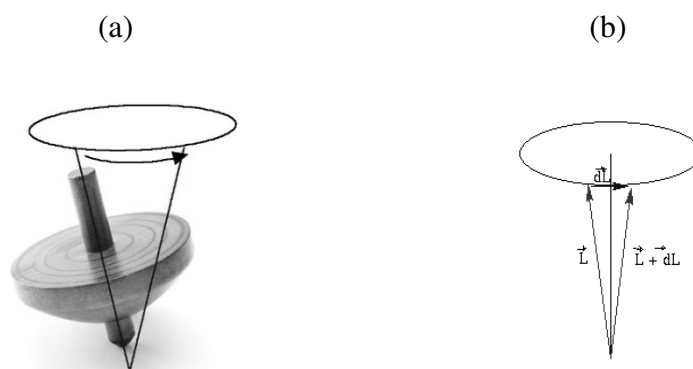
Figura 14: Precessão de um pião e representação de seu momento angular \vec{L} (a) e variação da direção da direção de \vec{L} (b).
