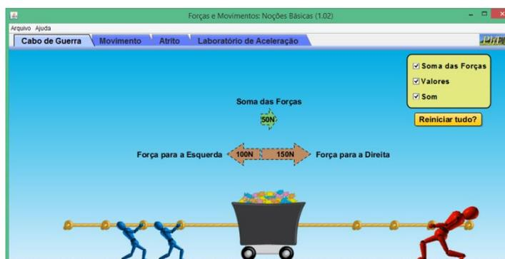
Figura 2: Tela do simulador computacional para se observar que se a força resultante diferente de zero, resulta num movimento acelerado.
