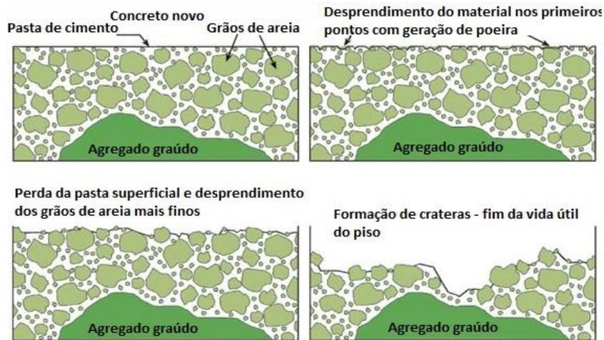
Figura 3 – Processo de perda de material por abrasão em superfície de concreto.
