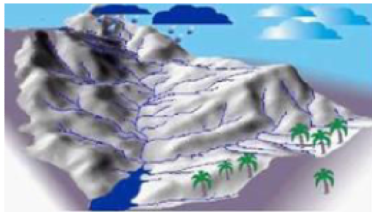
FIGURA 1 - Ilustração de uma bacia hidrográfica mostrando os divisores de água, as sub bacias e a drenagem principal
