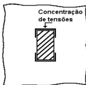
Figura 6 – Concentração de tensões nos cantos e no menor lado de pilares alongado
