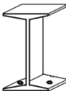
Figura 12 – Segmentos de perfis metálicos “I”, com furo para fixação.
