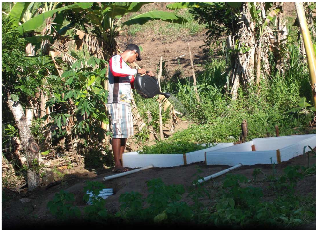
Figura 5. Aplicação de chuva simulada nas parcelas experimentais. Sítio Velho, Areia, PB.
