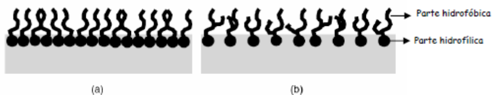
Figura 2: Esquema de adsorção das moléculas de surfactantes na interface: (a) maioria das cadeias hidrofóbicas é linear; (b) Presença de ramificação ou múltiplas cadeias hidrocarbônica.
