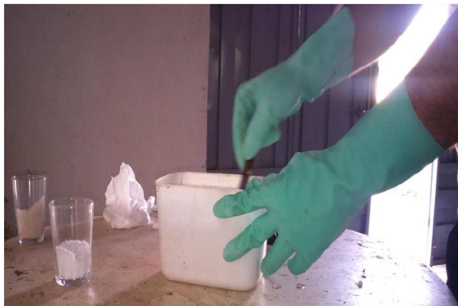
Figura 10 – Mistura-se a soda cáustica com o óleo usado.
