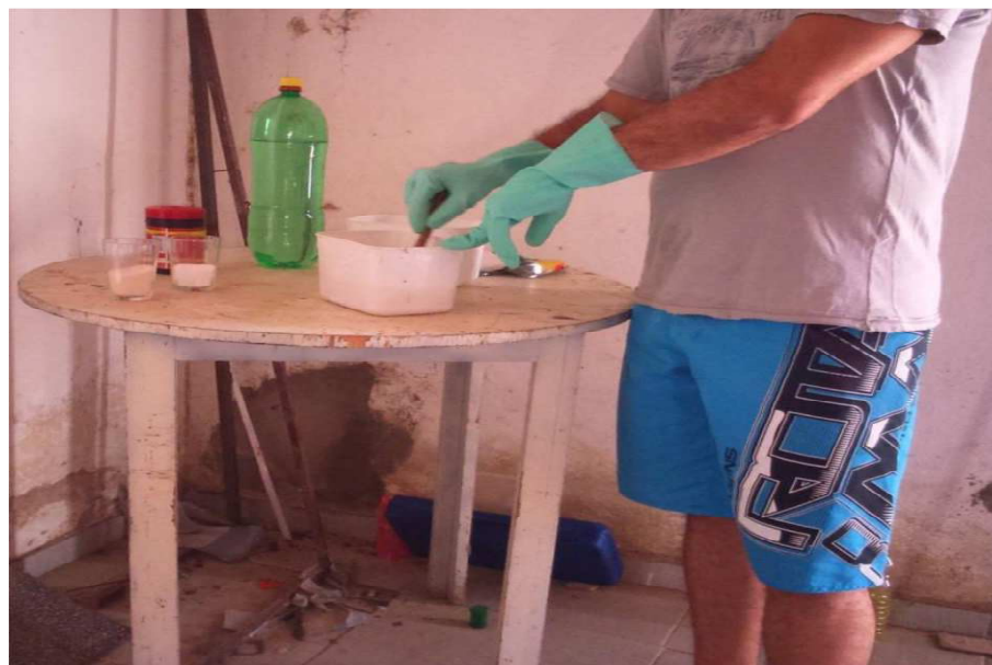
Figura 8 - Preparação da soda caustica em escamas, dissolvidos em água. Fonte: Acervo do autor.
