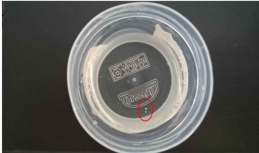
Figura 11 - Perda de massa dos corpos de prova (desintegração)
