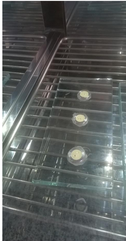
Figura 5 - Corpos de prova fixados com cera utilidade
