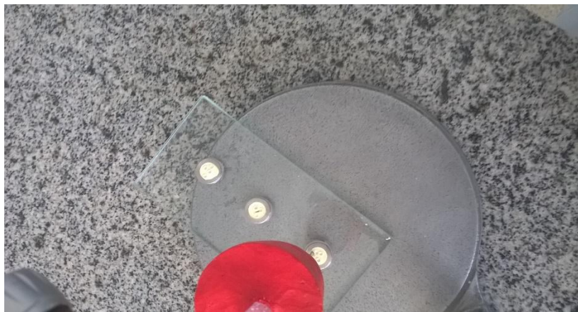
Figura 6 - Agulha de Gilmore disposta verticalmente sobre a superfície horizontal dos corpos de prova
