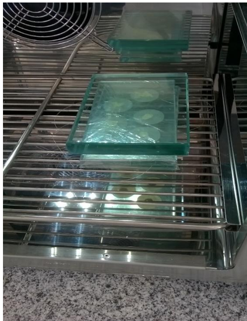
Figura 8 - Corpos de prova acondicionados em estufa à 37° C
