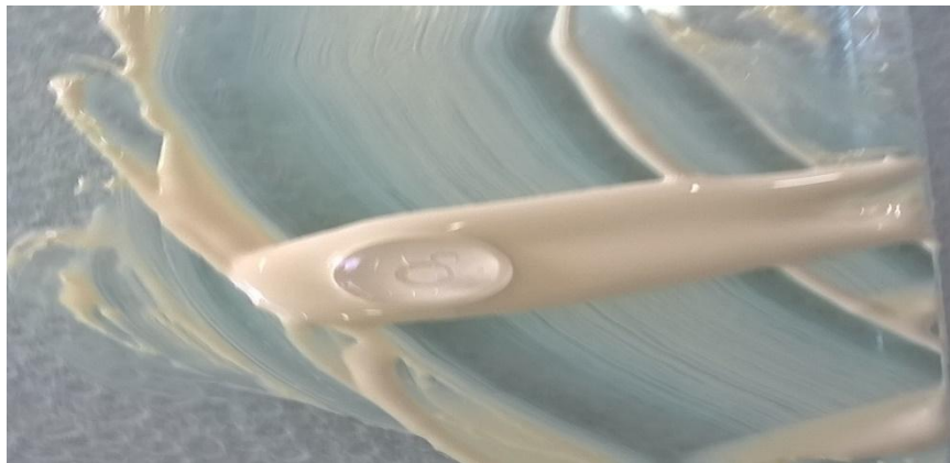
Figura 3 - Manipulação do cimento associado a solução de quitosana
