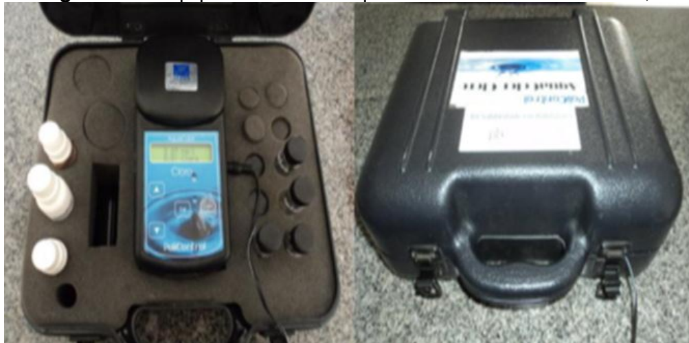
Figura 3.3 – Equipamento utilizado para medir o cloro residual livre,
