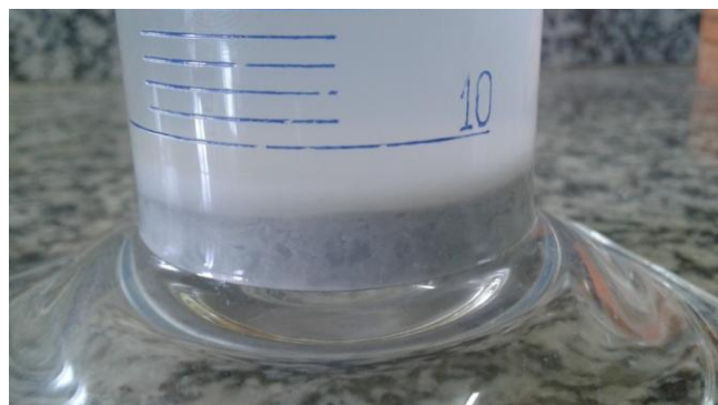
Figura 14 - Inchamento da bentonita rosa purificada em água.
