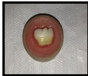
**Figura 3 (b):** Embutimento da amostra
