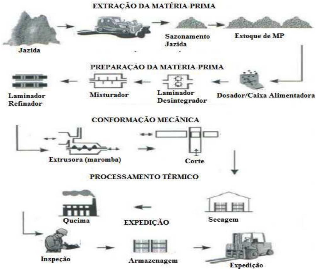
Figura 1- Esquema do Processo de Produção da Cerâmica do Tijolo Fonte: MEDEIROS (2012) apud VILLAR (1998), CAVALIERE et al. (1997), MAFRA (1999).
