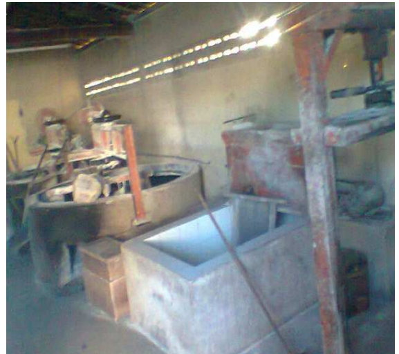
Foto 10: Parte interna da casa de farinha, contendo dois fornos (à esquerda), a moenda (no centro) e a prensa (canto direito). A mesma, localizada no Sítio Mumbuca, Alagoinha – PB e atende toda população circunvizinha, inclusive a do Assentamento Porções I. Foto do autor (Jun./2012).
