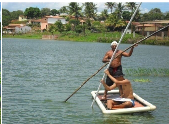
FOTO 04: Cano de PVC de 5 metros para medição da água e do material depositado, encontrado na lagoa do município de Lagoa de Dentro – PB.
