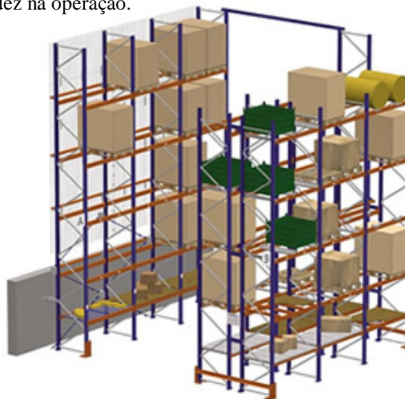
Figura 1: Exemplo de estrutura Porta-Paletes:
