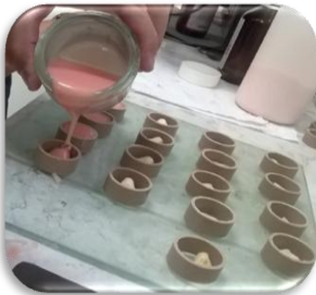
Figura F - Confeção dos corpos de prova.
