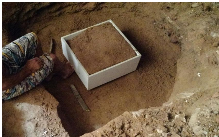
Figura 6 – retirada da amostra indeformada.
