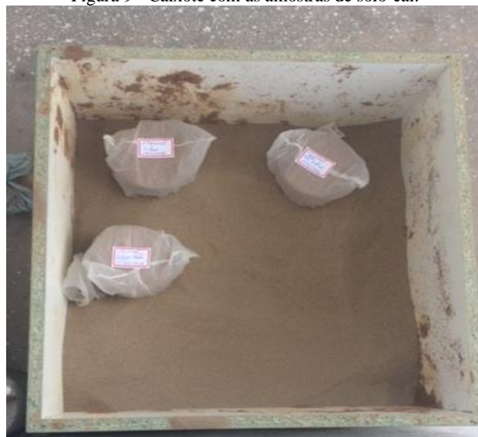
Figura 9 - Caixote com as amostras de solo-cal.
