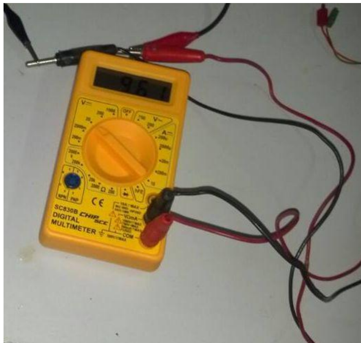
Figura 15: Multímetro com aferição de 9,61 Voltes.
