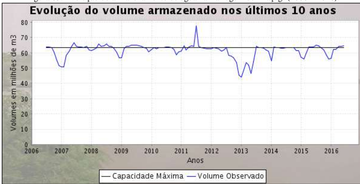
Figura 05: Evolução do armazenamento de água na Barragem de Araçagi (2006 – 2016).
