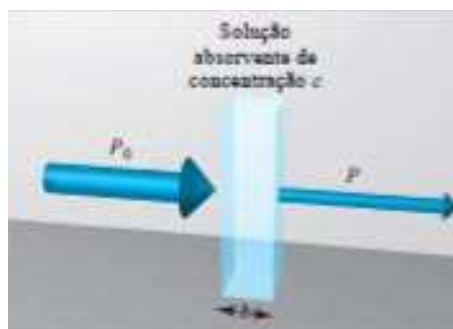
Figura 17 – Atenuação de um feixe de radiação por uma solução absorvente. A seta larga representando o feixe incidente significa maior potência radiante que aquela transmitida pela solução.
