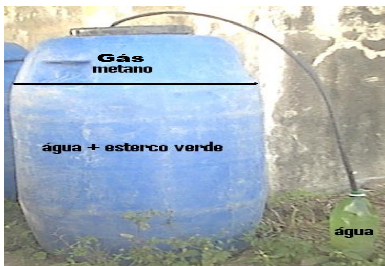
Figura 2. Ilustração do processo de produção do biofertilizante líquido comum.
