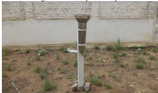
Figura 04 - Vista parcial do pluviômetro
